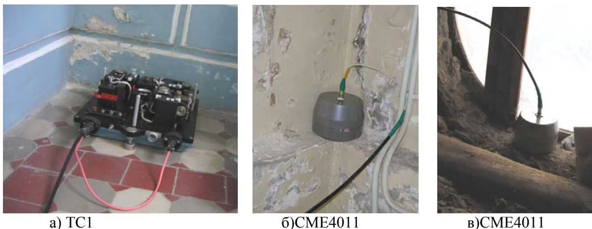
Рис.1. Сейсмоприемники вибродиагностического комплекса.
