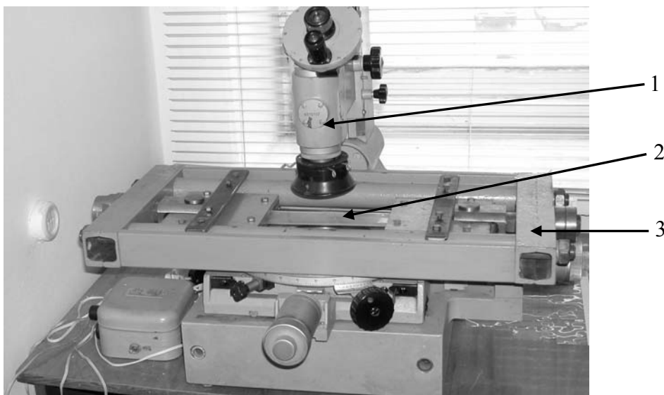
Рис.3. – Экспериментальная установка для регистрации эллиптичности, где 1 – оптический микроскоп, 2 – образец, 3 – нагружающее устройство
